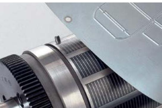
Positioniersystem mit Passbohrungen und Passstiften
