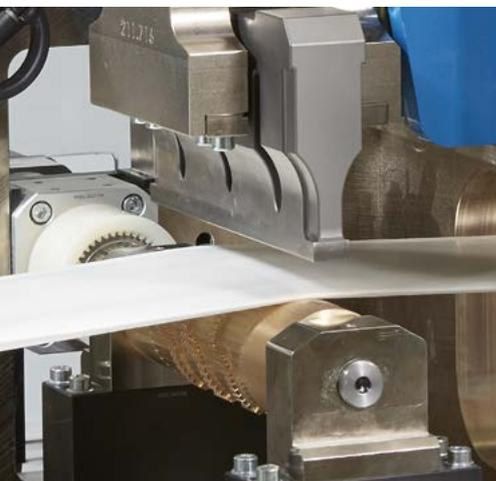
Die präzise gefrästen Ambosswalzen dienen als Gegenlager für die Sonotrode und bestimmen die Schweißkontur.
