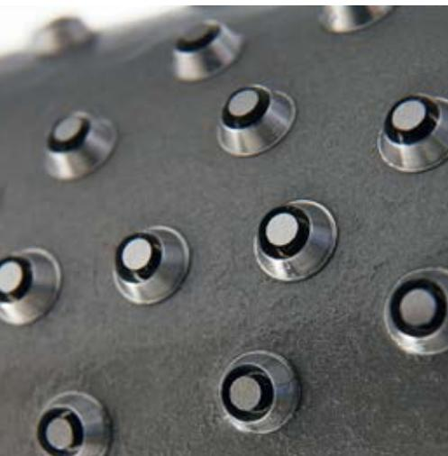
Die Auswerferstifte werden maschinell exakt auf die optimale Höhe geschliffen und mit einer Fase versehen.
