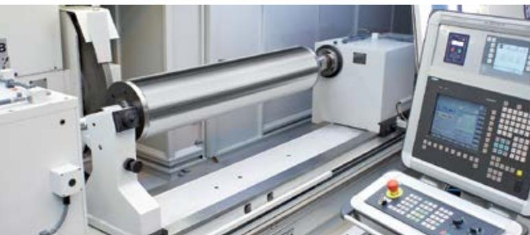
Auf modernsten CNC-Randschleifmaschinen werden die Zylinder und Passungen mit absoluter Genauigkeit geschliffen.
