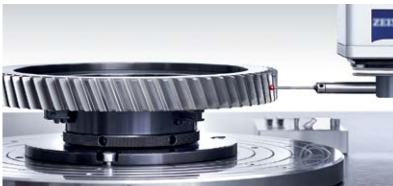
Prüfen der Verzahnungsqualität auf einer 3D-Messmaschine
