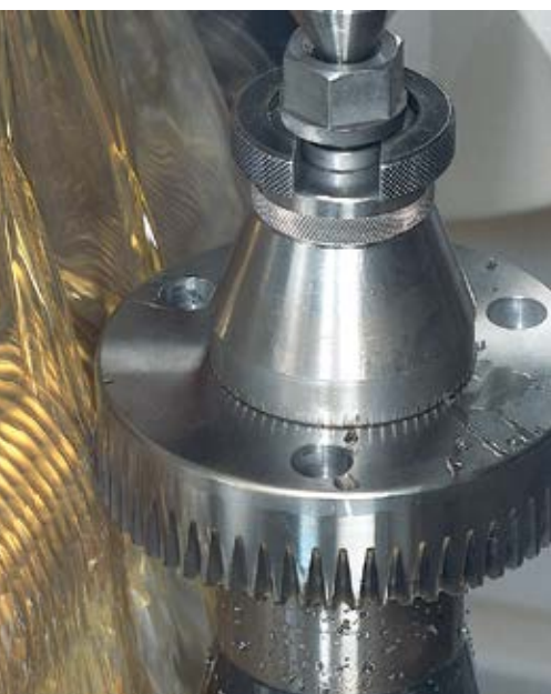
Verzahnung im Wälzfräsverfahren
