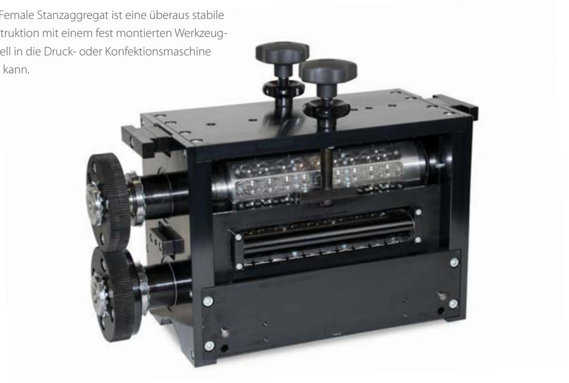
Die im Oberzylinder montierten und austauschbaren Stempel stanzen durch die Materialbahn, wobei der Abfall durch die im Unterzylinder befindlichen Buchsen geführt und anschließend zentral abgesaugt wird.
